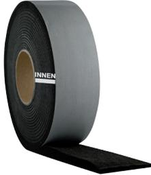
Das DRG-Multiband 3D ist ein neues speziell imprägniertes vorkomprimiertes Multifunktionsband zur Luft- und Schlagregenabdichtung sowie Dämmung von der Fensterbewegungsfugen. Spezielle Zonen im Band mit unterschiedlichen Raumgewichten sorgen für die Abdichtung nach dem Prinzip „innen dichter als außen“.
